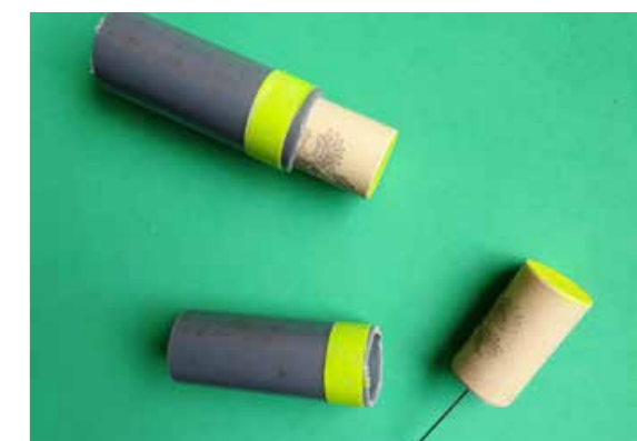
04 Solcherart aufbewahrte Nadel im Kunststoffrohr verhindert Stichverletzungen
